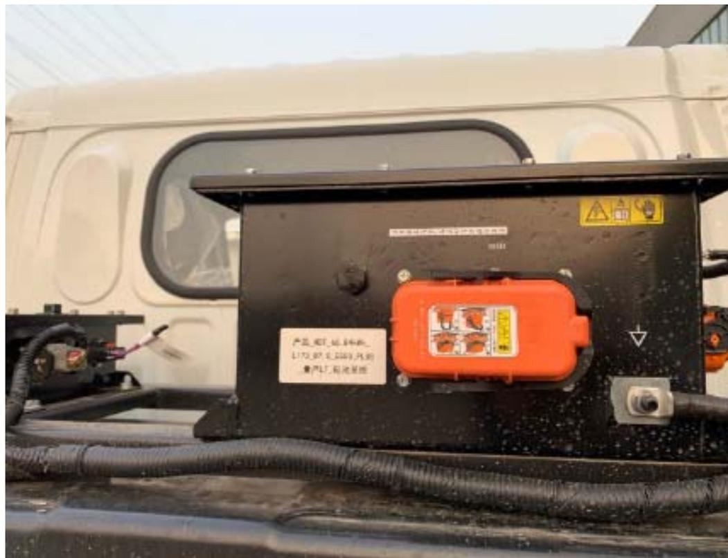
在电池上方设有维修保护开关。进行维修或检测前，必先拔下维修开关手柄，严禁带高压电进行操作。拔下的维修开关手柄必须妥善保管，直至检修完毕
